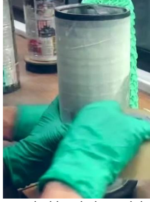
Resim 2: Hazırlanan mum kalıbı alçılama işlemi (GRN Döküm 2019)
